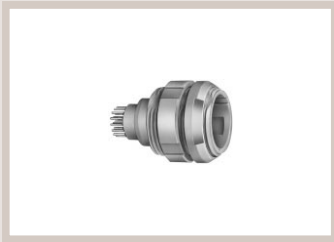
CKB Fixed socket with two nuts, with 90° contacts for printed circuit (back panel mounting) Apparatedose mit zwei Muttern, mit Kontakten 90° für gedruckte Schaltung (von der Rückseite der Frontplatte montierbar)
